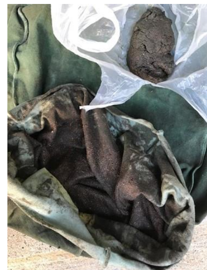
G社 機械加工マシニング のケラント液 (粘土状異物) カメラレンズ関係微細スラッジ捕捉
