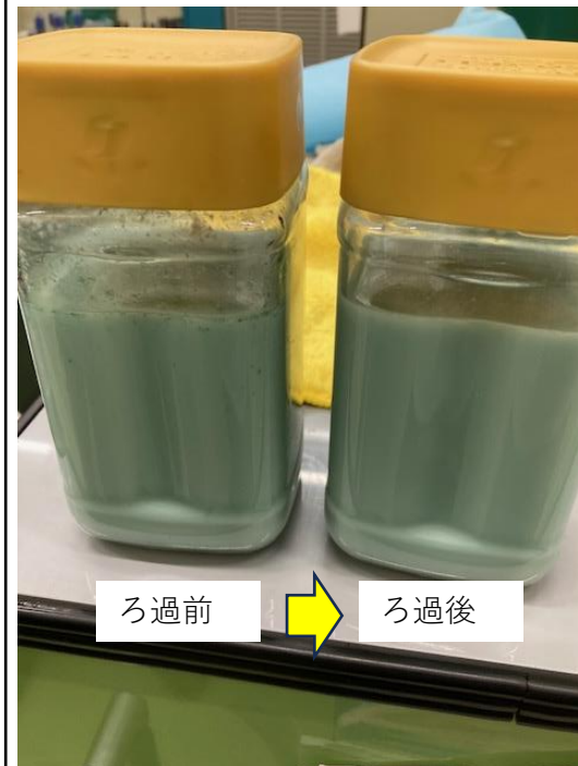
C社 銅の素材部品の加工マシン クーラント内 銅イオン溶け込み有り（青色）
