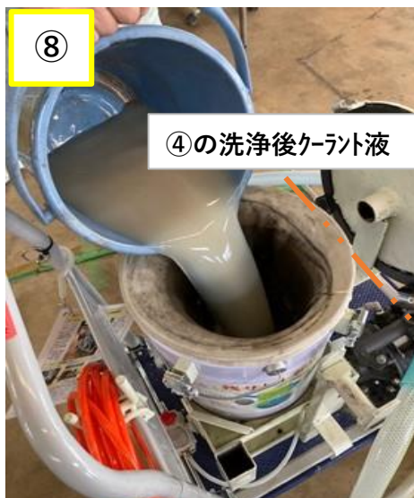
⑧ ④の洗浄後クーラント液は捨てることなくフィルター内へ投入
