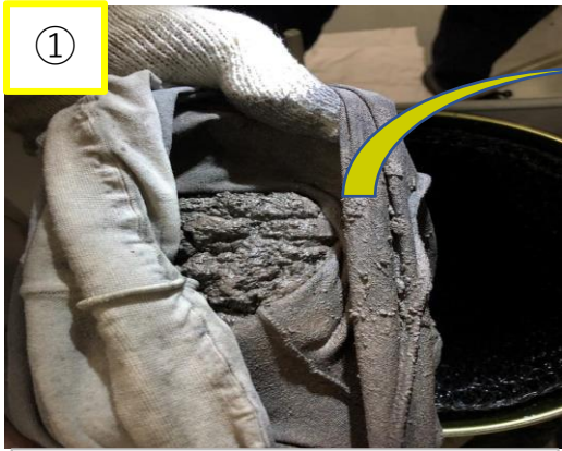
① フィルター内の補足切粉取り出し
