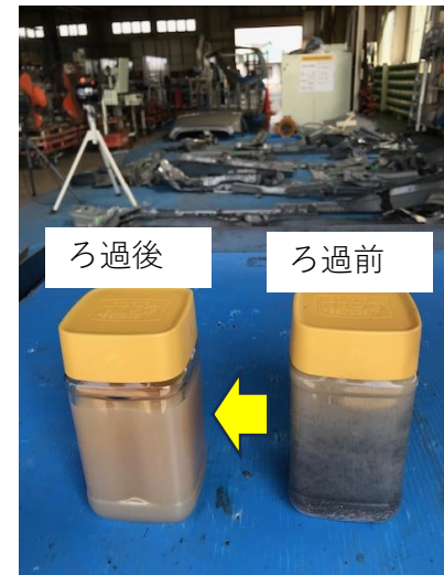
F社 機械加工マシニング のケラント液 ろ過後は黒いスラッジ は見えない
