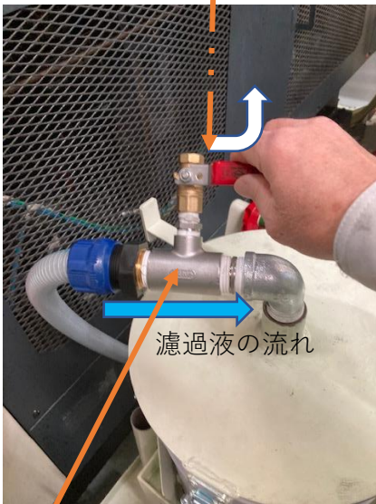
吸込みホース口90度ボールバルブ 濾過作業時のレバー位置 (閉鎖)
