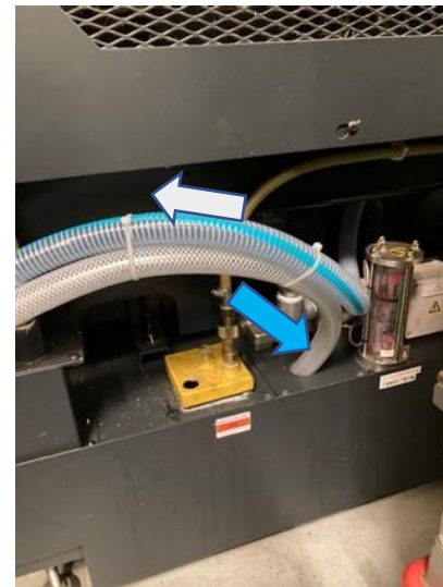
吐出ホースをタンク末端付近へ (タンク内流れ化の為)
