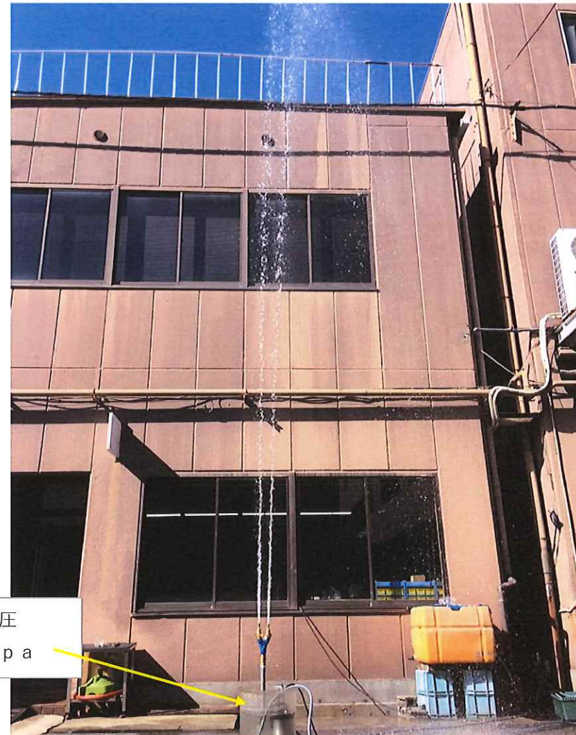
25A⇒V0 ジョイント にて20A分岐部より噴射
