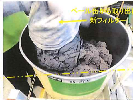
脱油後の新フィルターから取り出し (フィルターからは研磨粕を容易にへばり付きもなく取り出せる) フィルターは繰り返し再利用可 (目視で破れていないこと確認要)
