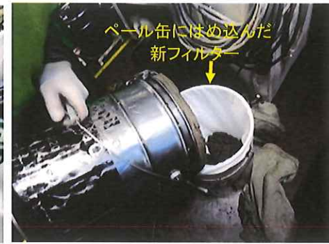
新フィルターへ研磨粕投入 (フィルター上部の綴じ方工夫要又少しフィルター内径を小さく出来る)
