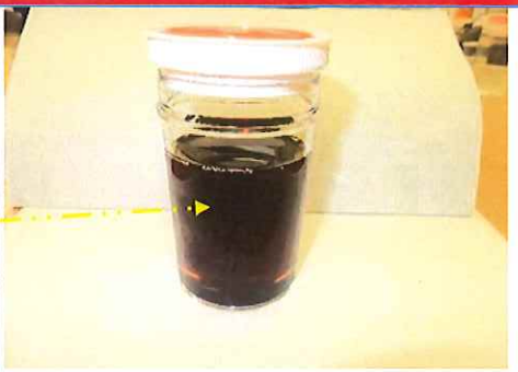
出口フィルター前より油採取 濾過精度: 平均粒子径10μ以下 (目視でもかなりクリーン化している そのまま研磨機のタンクへ投入可) クーラント液の完全リユース化 参考)特大フィルタートヨタ品番 Y 7 1 4 1 - 1 2 4 3 6
