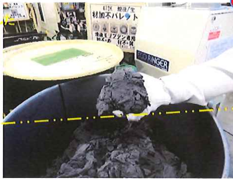
脱油後の研磨粕(従来同等) パサパサの研磨粕となっている。 (廃棄物処理費も低減)
