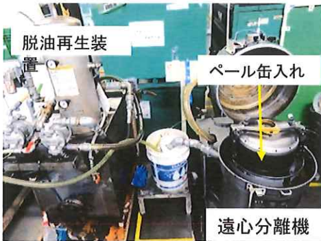
遠心式脱油装置の全体
