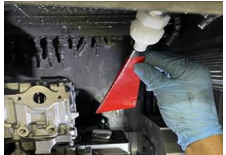
加工設備内でのノズル角度の調整 実務状態事例 (NA-L1 使用)
