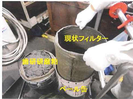
現状ペール缶式脱油装置 (現状フィルターはコシはあるが破れ 易く濾過制度も悪い)
