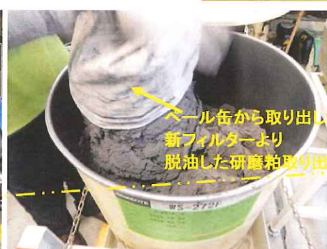
脱油後の新フィルターから取り出し (フィルターからは研磨粕を容易に へばり付きもなく取り出せる)
