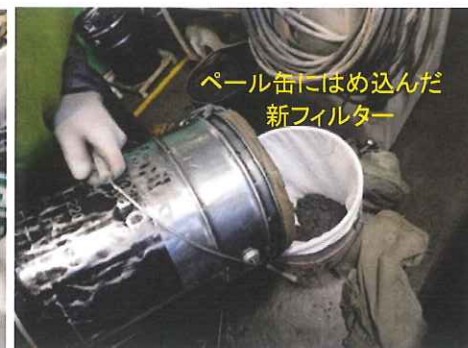
新フィルターへ研磨粕投入 (フィルター上部の綴じ方工夫又 少しフィルター内径を小さく出来る)
