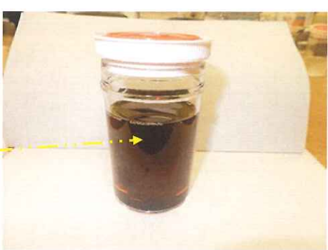
出口フィルター前より油採取: 粒度分布分析 (目視ではかなりクリーン化している 再生装置に負荷軽減・故障低減になる) 分析結果: 平均粒子径10μ以下のろ過精度
