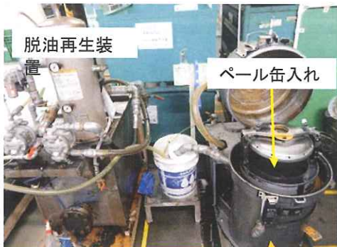
遠心式脱油装置の全体
